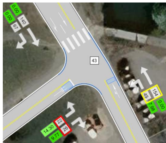
Slika 43: kapacitetna preveritev križišča K43 ob spremembi glavne smeri (Cvetlična ulica) v jutranji konici
